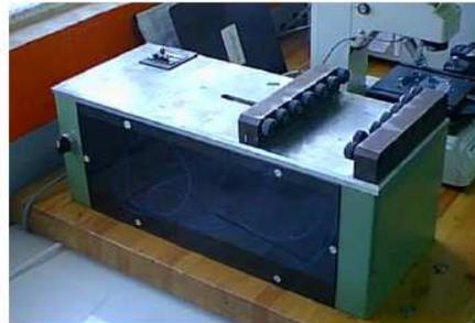
Figura 13.- Prueba de resistencia al quebrado de los tubos holgados.
