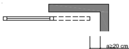
Figura 2.1 Holgura para evitar atrapamientos
