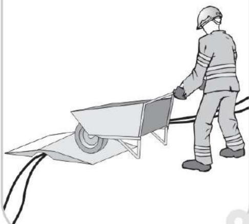
protección de conductores
