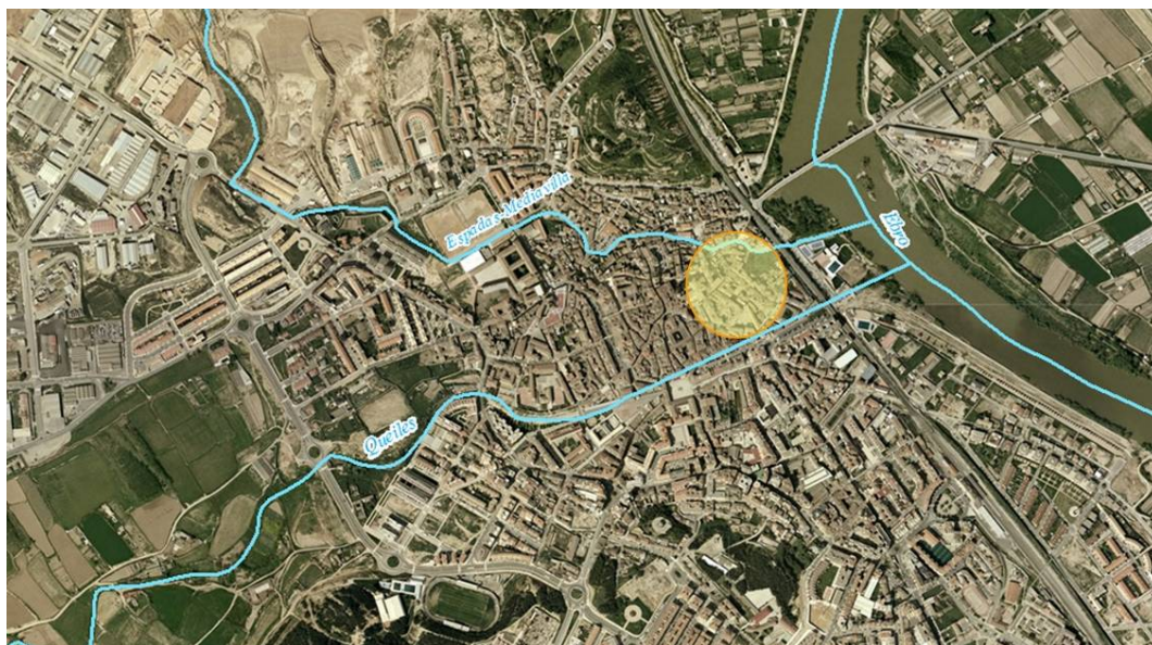
Fig.1: Ortofoto de Tudela con los 3 cauces (Ebro, Queiles y Mediavilla) y la ubicación de las zonas inundables por desbordamiento de la red de saneamiento en caso de avenida en el Ebro
