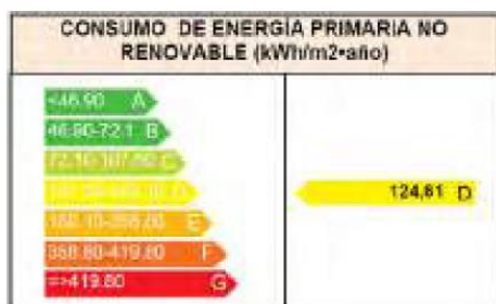
Consumo de Energía Primaria No Renovable según Estado Actual.
