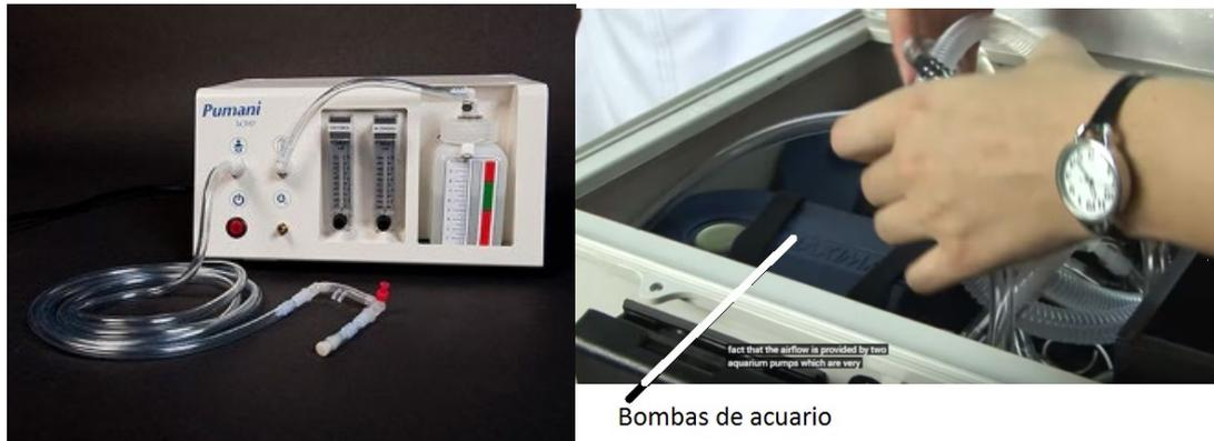
Figura 3.- Izda. Unidad CPAP Universidad Rice. Dcha. Detalle del interior del sistema CPAP de la Universidad de Rice, en el que se pueden ver las bombas de aire
