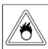
PELIGRO! MATERIAL COMBURENTE
