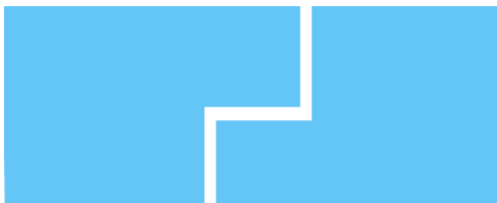
Juntas perimetrales a media madera
