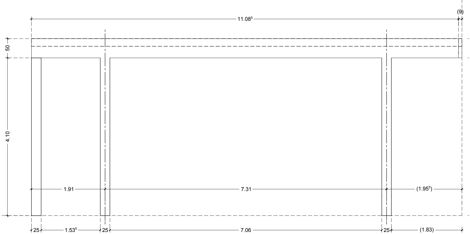
ALZADO SUR DEL PORTICO EXTERIOR
