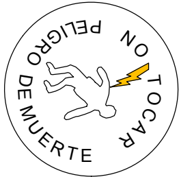
Señal de peligro de muerte
