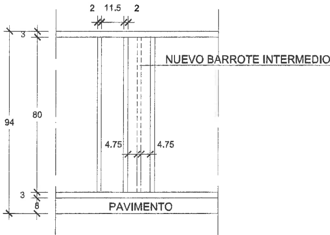
DETALLE REFORMA DE BARANDILLA
