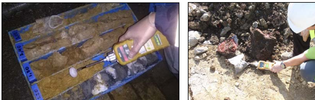
Figura 4. Ejemplo de medidas de volátiles en investigación de suelos contaminados
