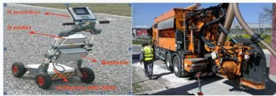
Detalle de georadar y de equipo para ejecución de microzanja.
